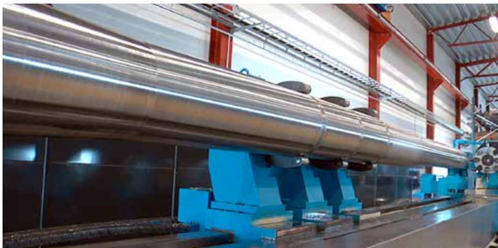
Bearbetning av en 15 ton tung propelleraxel hos KMV.
