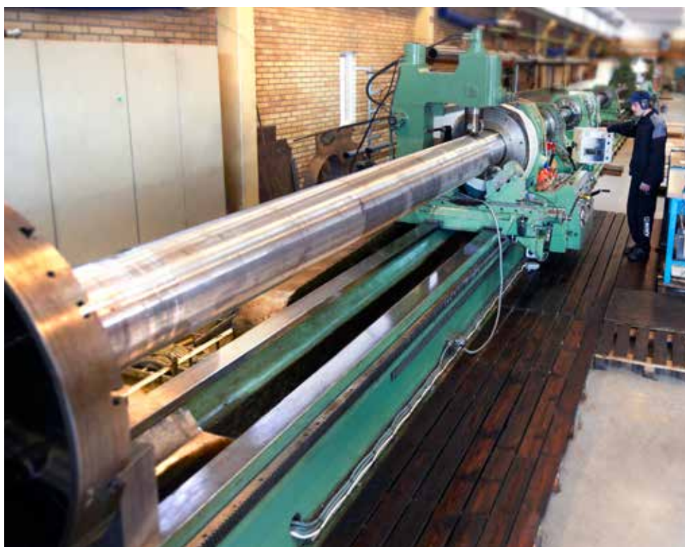
Långhålsbörning i längder upp till 13 m hos KMV i Kungsör.
